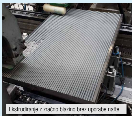
Novo razvita plata za ekstrudiranje z luknjicami, skozi katere piha zrak
