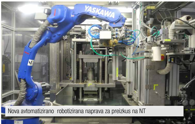
Preizkuševalni del nove naprave z vpenjalnimi elementi
