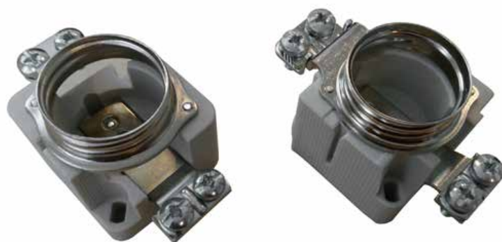
Podstavek DIII pred prenovo in po prenovi.
