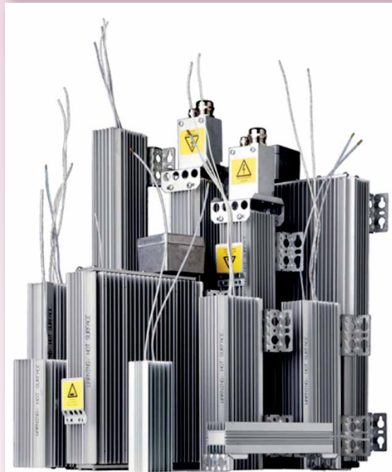
Primeri zavornih uporov v aluminijastih ohišjih, znotraj katerih so vgrajeni kordieritni nosilci spiral P18018-4.
