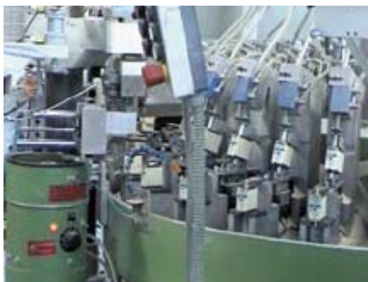
Iz proizvodnje: linija za peskanje NV varovalk
