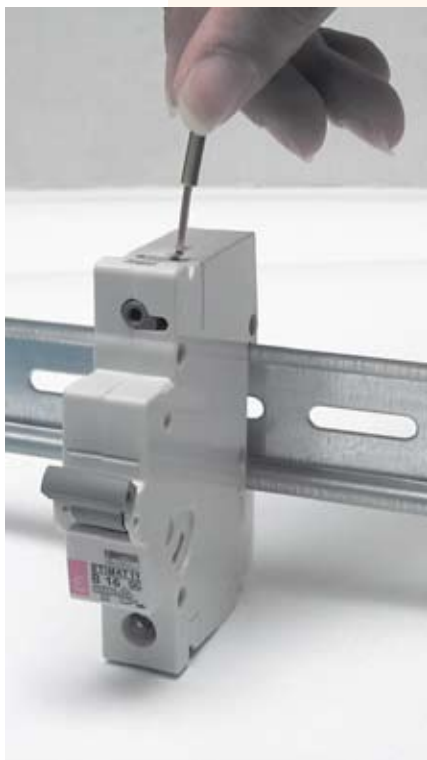
Koristite kruti vodič presjeka od 1,5 do 4 mm 2
