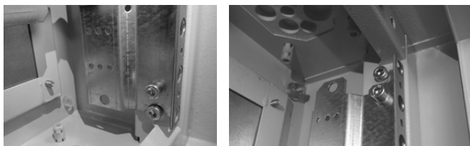
Slika 17: Pritrjevanje nosilcev WP-A na ohišje
