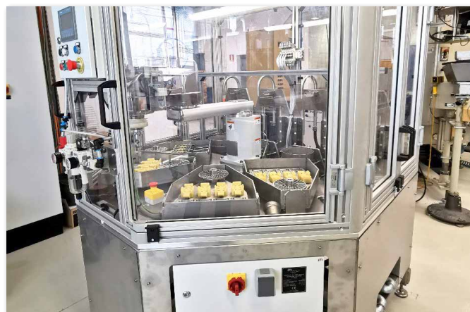
Naprava za prelaganje magnetnih sistemov
