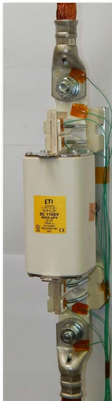
Testiranje PK podstavka skupaj s talilnim vložkom
