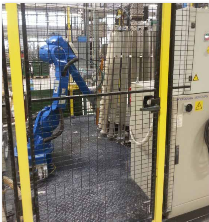
Priprava cevi na vrtanje s pomočjo robota
