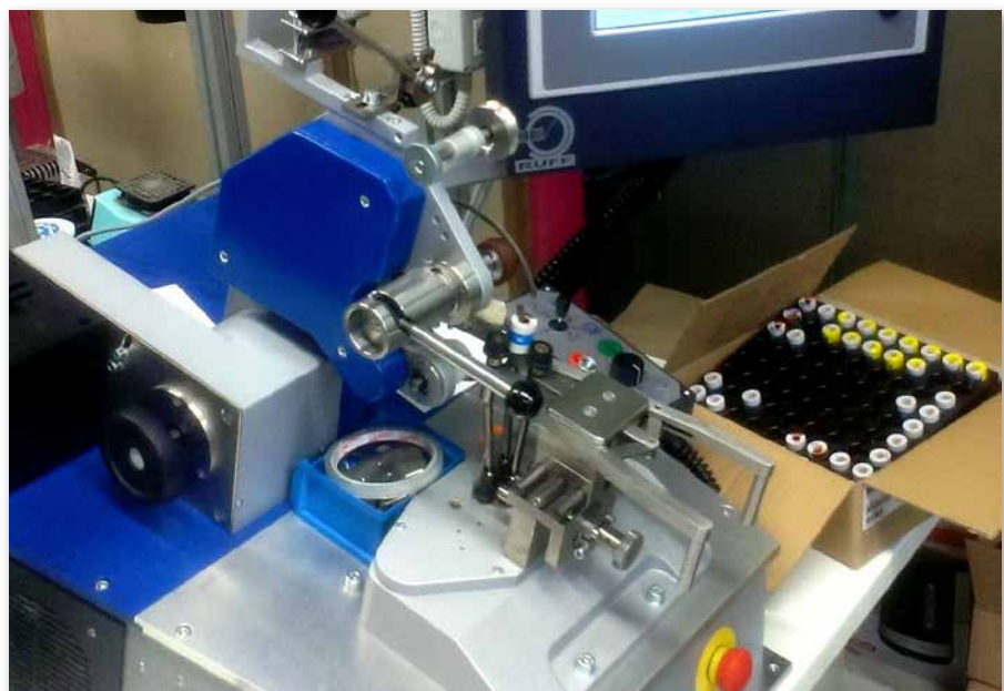
Nova naprava za izdelavo sekundarnega navitja
