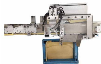
Avtomatska kontrolna naprava za preverjanje prisotnosti sestavnih delov v ločilnikih
