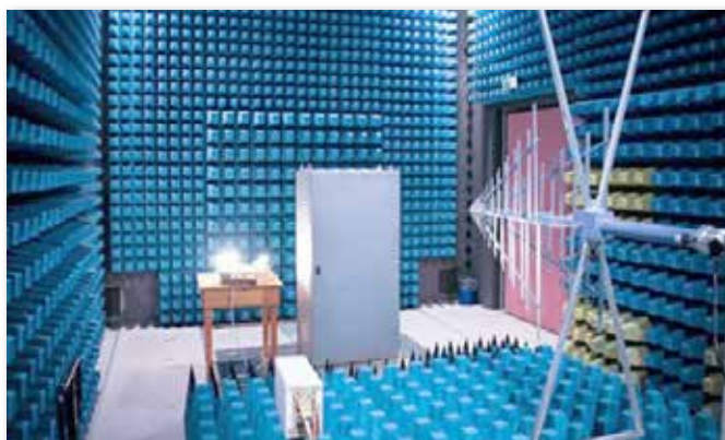
Prostor za testiranje elektromagnetne združljivosti EMC [8]
