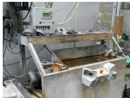
preizkus vzdržljivosti cevi na notranji tlak
