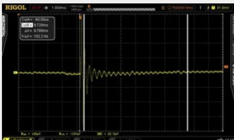
Drugi sklop meritev je bil izveden na podlagi simulacije napake na frekvenčnem pretvorniku. Iz njegovega DC-linka smo izvedli povezavo na ozemljitev preko spremenjajočih uporov in na ta način nastavili tok napake. Merili smo obliko in vrednost toka, ki je prikazana na spodnjih slikah. Zelo jasno se vidi enosmerna komponenta, ki ji je superponiran izmenični del. To pa je ravno tisti preostali tok, na katerega lahko reagira samo B-tip RCCB-ja.
