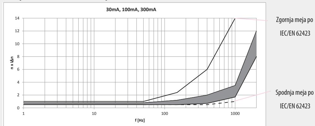
Po standardu IEC/EN 62423 je določeno področje izklopa pri frekvenci 50Hz med 0,5-kratnikom in 1-kratnikom nazivnega diferenčnega toka. Pri frekvenci 1kHz pa je področje izklopa omejeno med 1-kratnikom in 14-kratnikom nazivnega diferenčnega toka. Kot lahko vidimo naš B-tip dosega izklopni diferenčni tok pod 14-kratnikom nazivnega diferenčnega toka tudi pri frekvenci 2kHz, kar prikazuje osenčeno področje v grafu.
