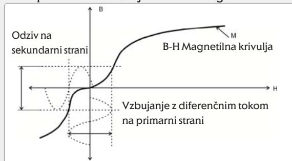
Zgoraj je prikazana B-H magnetilna krivulja diferenčnega transformatorja. Magnetna poljska jakost je odvisna od vzbujanja z diferenčnim tokom, v jedru transformatorja se pojavi magnetni pretok B, v skladu s potekom B-H krivulje. Zaradi dovolj velikega magnetnega pretoka B se inducira napetost na sekundarni strani in le-ta požene tok proženja v prožilnem releju.
