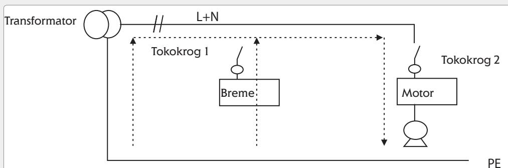
Zgoraj je enostaven primer dveh tokokrogov. V tokokrogu 1 je vključen porabnik, ki ne povzroča visokofrekvenčnih motenj, v tokokrogu 2 z motorskim pogonom pa je vključen frekvenčni konverter, ki povzroča visokofrekvenčne motnje. Zaradi kapacitivnosti med porabniki, kablji in vodnikom PE prihaja do visokofrekvenčnih tokov, ki tečejo skozi vodnik PE in se superponirajo s tokom napajanja.
