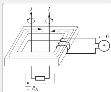
V primeru, ko je vsota pritekajočih in odtekajočih tokov skozi primarno navitje enaka 0, se na sekundarni strani transformatorja ne inducira tok in aparat se ne izklopi.
