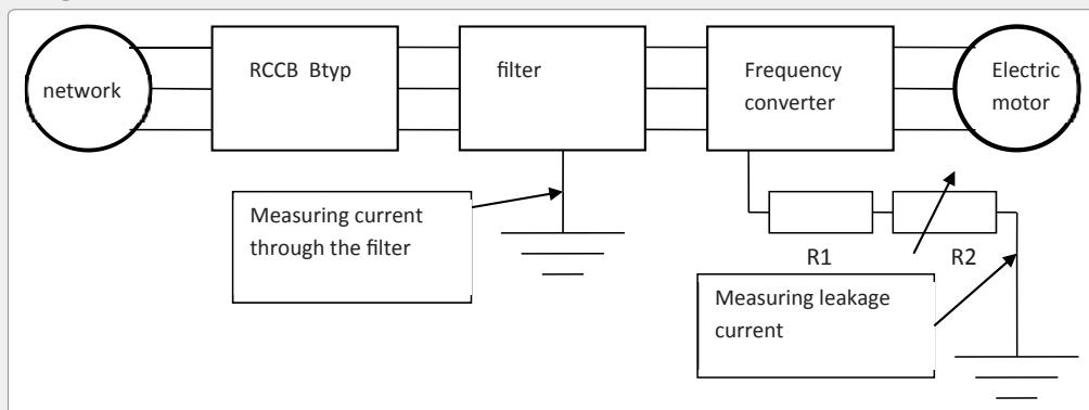
Prvi sklop meritev je bil izveden z namenom izmeriti dejansko obliko in vrednost toka ozemljenega filtra pri vklopu celotne vezave. Ob vklopu lahko pride zaradi polnjenja kondenzatorjev v filtru do »zagonskega« toka (oz. odvodnega toka), ki bi lahko povzročil neželeni izklop RCCB stikala B-tip. Prva slika prikazuje dejansko izmerjen odvodni tok v trenutku vklopa. Izvedeni sta bili dve meritvi z različnima filtroma.
